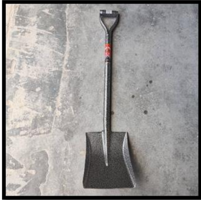
7. PENYODOK TANAH SAMA DAN BATANG BESI (SKOP)
